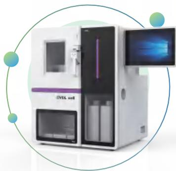
毫升体系微生物适应性进化仪 (EVOL cell) 是基于高气体透过性微管路及单相微流控技术开发而成的微生物驯化装备, 具有微生物培养、传代、化学因子梯度添加、氧分压控制等功能。仪器以微管路作为微型生物反应器, 对多种气体 (氧气、氮气、二氧化碳等) 具有良好的渗透性, 充分满足培养过程气体交换需求。利用氧分压控制技术, 可以灵活调控反应器周围气体环境, 从而应用于多种微生物的培养和适应性进化。
